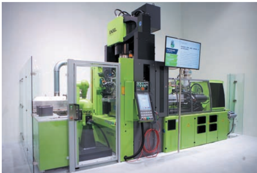
Фото 2. Композитная педаль тормоза, изготовленная в производственной ячейке на основе литьевой машины ENGEL insert 1050H/200
