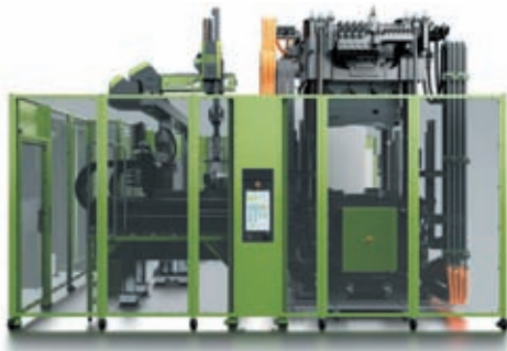
Фото 6. Производственная ячейка на базе литьевой машины ENGEL v-duo 1560/700, на которой изготовлены лопаты из полиамидного стеклопластика с применением полимеризации \epsilon -капролактама в форме
