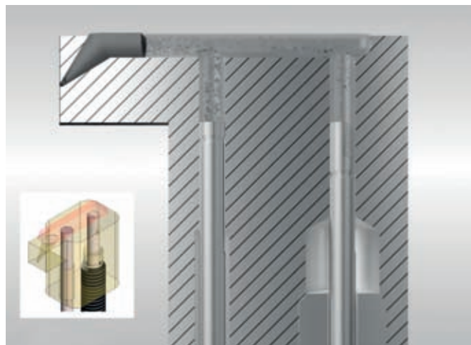
Рис. 4. Схема удаления воздуха из формы по принципу HeiNo (источник рис. 4–11: KB Hein)
