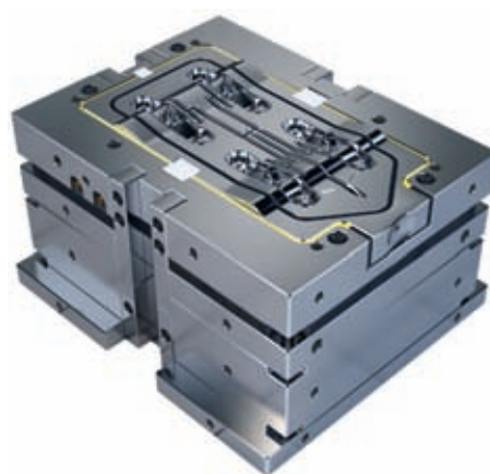
Рис. 2. Вид на часть формы типа IsoForm со стороны выталкивающей системы, предназначенной для изготовления РТИ и имеющей по три формообразующие вставки в каждом из четырех оформляющих гнезд
