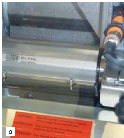
Фото 2. Узел пластикации с 8-миллиметровым шнеком (а) может применяться не только для переработки термопластов, но и силиконов на серийно выпускаемых литьевых машинах моделей Boy XXS (б) и XS (в) с усилиями смыкания 63 или 100 кН соответственно
