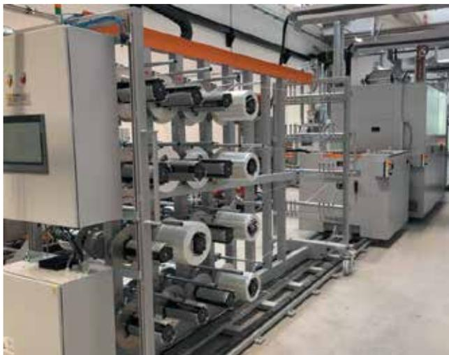
Рис. 10. Вид со стороны шпулярника с катушками с армирующими нитями на линию на основе экструдера ZSE 27 iMAXX для производства однонаправленных лент
