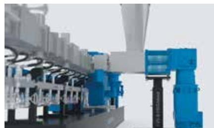
Рис. 8. Боковой питатель серии ZS-B MEGAfeed (справа) позволяет подавать в экструдер-компаундер (слева) рециклят с очень малой насыпной плотностью – менее 200 кг/м<sup>3</sup>
