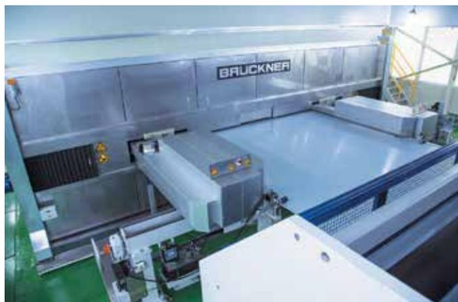
Рис. 4. Узел модернизированной линии для производства сепараторных БО-пленок
