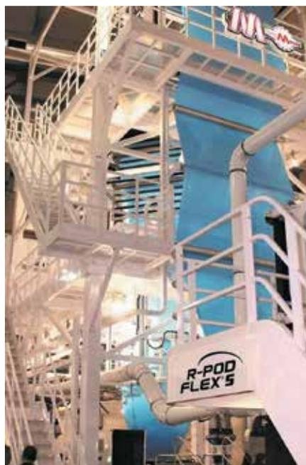
Рис. 2. Новая высокопроизводительная экструзионно-раздувная линия R-POD Flex 5 (источник: Macchi)
