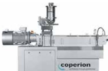
Рис. 6. Лабораторный экструдер модели STS 25 Mc<sup>11</sup>
