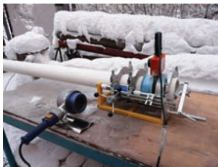
Фото 6. Проведение эксперимента по сварке труб при минусовых температурах окружающей среды (источник: ИПНГ СО РАН)
