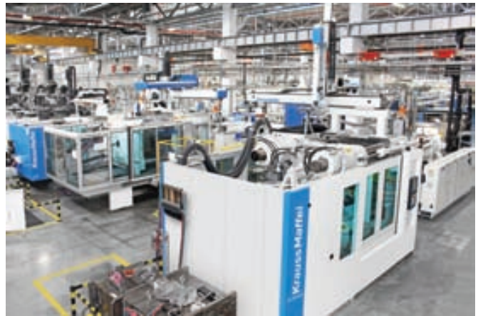
Фото 4. Парк оборудования компании Elba: наряду с переработкой ВМС на машине CX 420 Polyset на машинах компании KraussMaffei перерабатываются также термопластичные материалы (фото: KraussMaffei)
