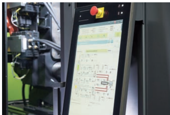
Фото 2. Контроль и управление всем технологическим процессом, включая переработку полиуретана, осуществляется через систему управления CC300 литьевой машины
