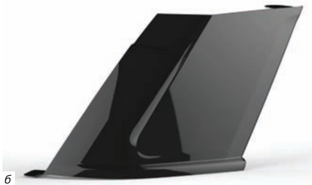
Фото 1. На выставке Fakuma-2017 на литьевой машине из серии ENGEL duo (а) с применением технологии clearmelt изготавливались задние стойки кузова для одного из современных внедорожников (б) (фото 1–3: ENGEL)
