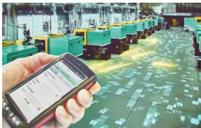
Фото 2. Компьютерная система управления ALS обеспечивает последовательную информационно-техническую связь между этапами производства литьевых изделий; новинкой здесь является модуль «мобильное техобслуживание» для мобильных устройств
