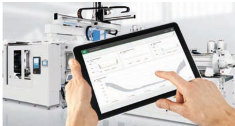
Благодаря новой системе DataXplorer, впервые появилась возможность получения от литьевой машины исчерпывающего объема информации о технологическом процессе (все иллюстрации: KraussMaffei)
