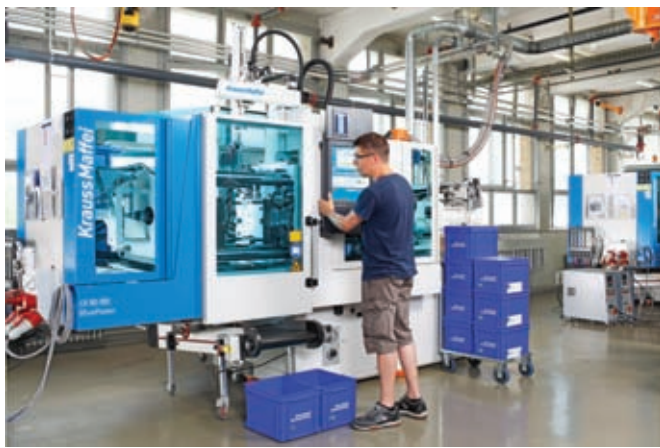
Применение недельного таймера позволяет точно установить момент начала работы машины в нормальном производственном режиме и тем самым исключить ненужное время ожидания
