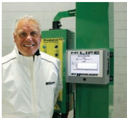
Фото 3. Система HiLife охватывает все важные для процесса данные на автомате для обмотки грузов стретч-пленкой. На фото – основатель фирмы Highlight Industries Курт Рименшайдер (источник: Highlight Industries)
