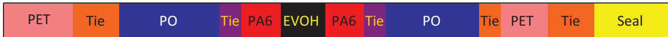
Рис. 1. Структурная схема 13-слойной высокобарьерной пленки для глубокой вытяжки (без соблюдения масштаба) (источник: W&H): высокобарьерный блок PA/EVON/PA расположен между слоями PO и PET, а между ними – слои адгезива (Tie); справа – соединенный адгезивом слой для тепловой сварки пленки (Seal)
