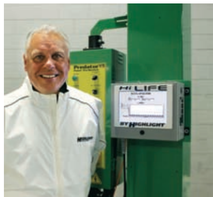
Фото 3. Система HiLife охватывает все важные для процесса данные на автомате для обмотки грузов стретч-пленкой. На фото – основатель фирмы Highlight Industries Курт Рименшайдер (источник: Highlight Industries)
