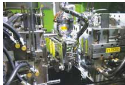
Фото 4. Линейные роботы vipac размещают ножи и заготовки в литые формы, а также извлекают их из форм по окончании соответствующей стадии общего цикла литья под давлением
