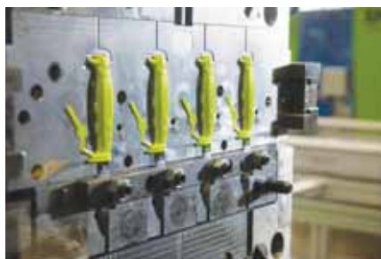
Фото 3. На первой стадии цикла осуществляется формование первого, внутреннего слоя рукояток из полипропилена по технологии окружного литья
