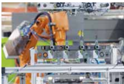
Фото 2. С закрепления четырех лезвий на несущей планке начинается производственный процесс. Каждая группа из четырех ножей извлекается из магазина более крупным из двух многоосевых роботов
