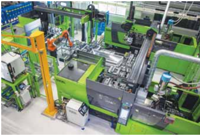
Фото 1. Вид с разных сторон на высокоинтегрированную и полностью автоматизированную производственную ячейку, которая позволяет производить 480 ножей в час и которую сотрудники компании Morakniv ласково называют «Габриель» (все фото: ENGEL)
