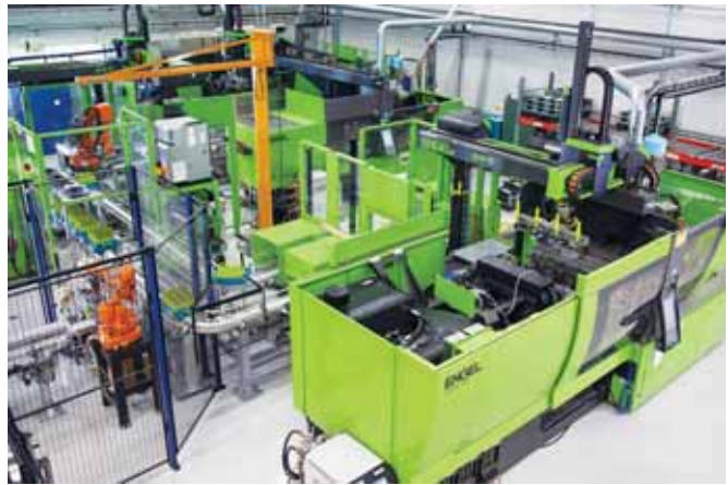
Фото 1. Вид с разных сторон на высокоинтегрированную и полностью автоматизированную производственную ячейку, которая позволяет производить 480 ножей в час и которую сотрудники компании Morakniv ласково называют «Габриель» (все фото: ENGEL)
