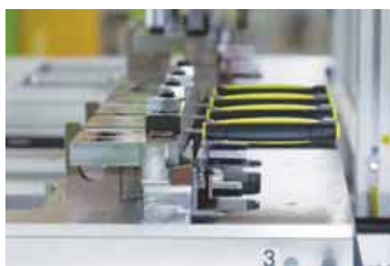
Фото 6. Вплоть до завершения процесса изготовления рукояток блоки из четырех ножей остаются зафиксированными на несущих планках. После этого они снова захватываются большим роботом
