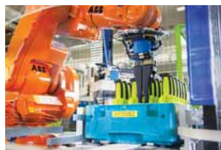
Фото 7. Меньший из двух многоосевых роботов извлекает готовые изделия из коробок для размещения их в торговых контейнерах
