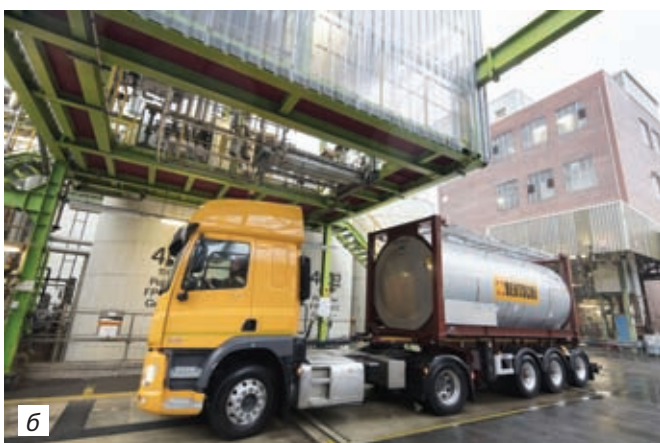
Фото 2. Начало загрузки нового полиола (а), который за короткое время в количестве 18 т будет перекачан в цистерну (б) (фото 2–4: Covestro)
