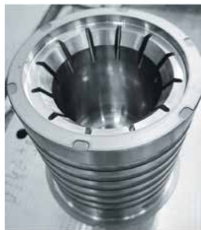
Фото 3. Внешний вид изделия «колпак» (а) и характерное месторасположение трещины на колпаке (показано стрелками) (б)
