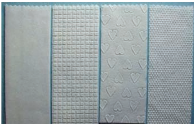
Фото 4. Салфеткам санитарно-гигиенического назначения можно придавать различные рельефные эффекты непосредственно в процессе гидроструйного скрепления холста на установке AquaJet (фото: Fleissner)
