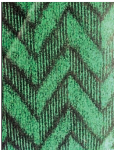
Фото 1. Структурированное (ворсовое) иглопробивное полотно с петлевым ворсом, изготовленное на иглопробивной машине серии DI-LOOP (фото: Rostoi Sugd)
