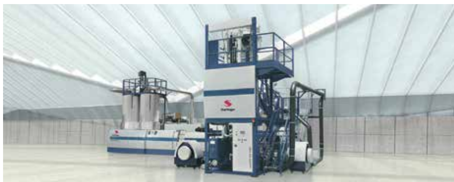
Рис. 1. Установка recoSTAR PET по переработке ПЭТ-бутылок в высококачественный регранулят для производства новых бутылок, волокон и другой продукции (рис.1–3: Starlinger)
