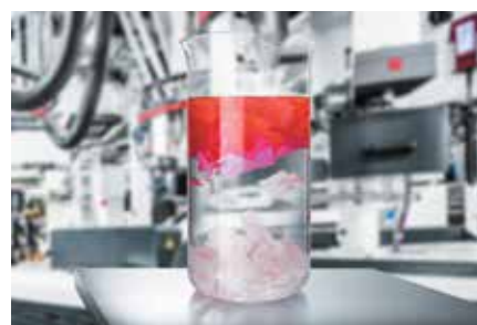
Рис. 16. Результаты разделения отходов барьерной пленки на ПА и ПЭ (источник: W&H)
