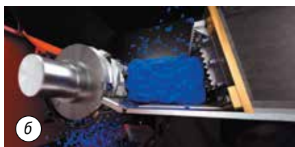
Рис. 13. Одновалковый промышленный шредер W5.18 (а) и его рабочая зона (б) (источник: рис. 13–14: Weima)
