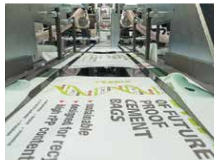
Рис. 3. Установка ad*starKON SXneo, предназначенная для производства «цементных мешков будущего» на основе смесей первичного и вторичного ПП или ПЭТ
