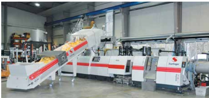
Рис. 2. Установка recoSTAR dynamic 145 с производительностью 1000 кг гранулята в час
