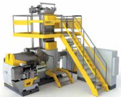
Рис. 11. Установка жидкофазной поликонденсации отходов ПЭТ (источник: NGR)
