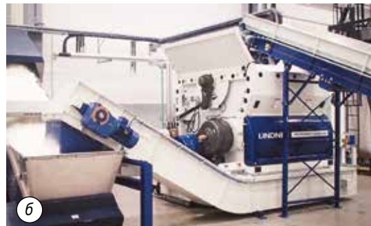
Рис. 10. Универсальный шредер серии Micromat HP в отдельности (а) и в составе технологической линии (б) (источник: Lindner)
